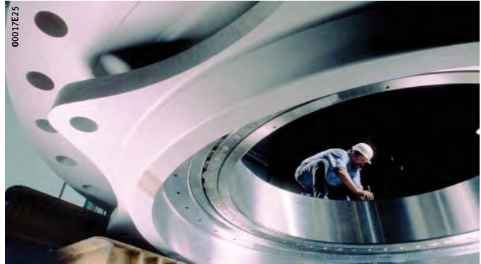
Figura 5 Montaje de un rodamiento grande
