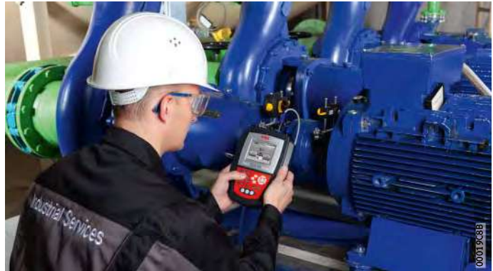
Figura 3 Dispositivo de alineación de ejes Top-Laser EQUILIGN
