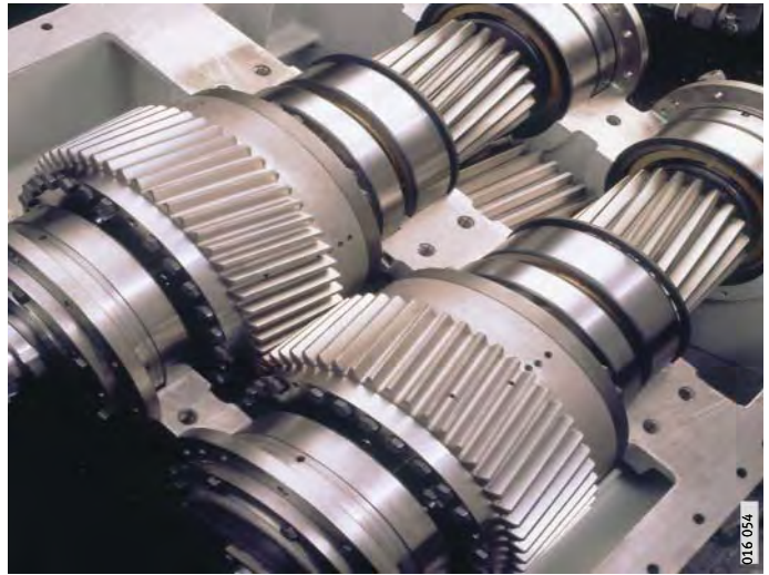
Figura 6 Rodamientos en un reductor de ruedas con dentado helicoidal
