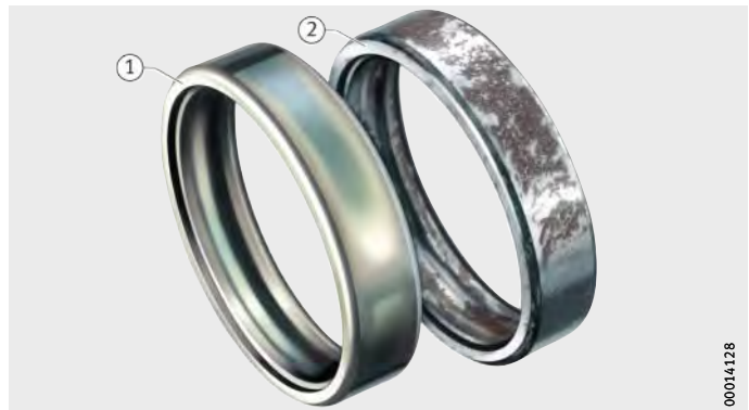
Figura 11 Anillos de un rodamiento después del ensayo de niebla salina
