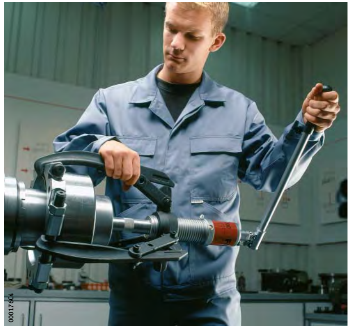
Figura 1 Desmontaje de un rodamiento con extractor hidráulico
