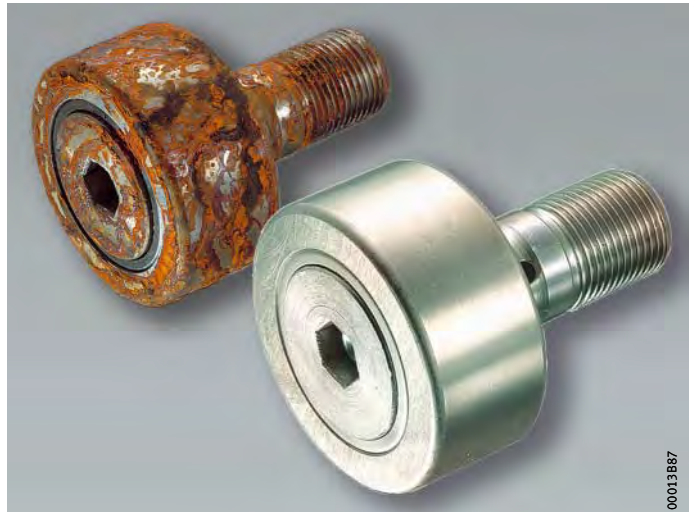
Figura 25 Rodillos de levas sin y con recubrimiento después de un ensayo de niebla salina
