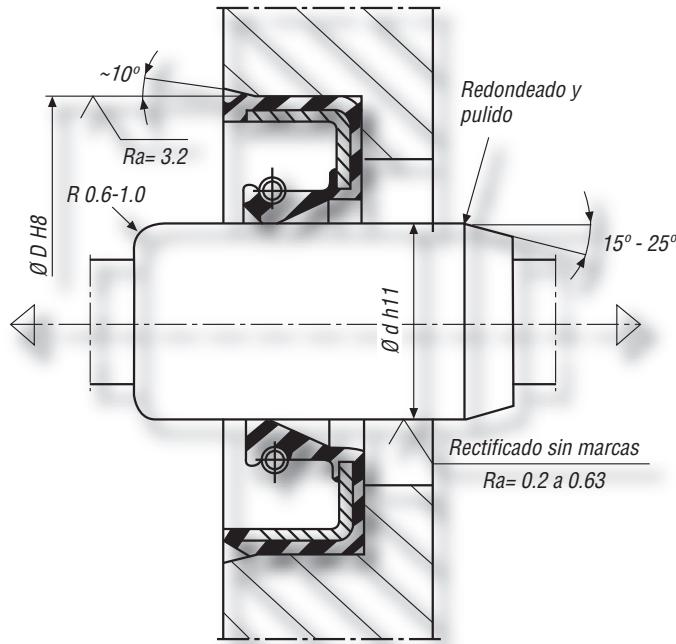
Antes de montar el retén, además de comprobar las particularidades de la aplicación y las características constitutivas del retén, es necesario comprobar las condiciones del orificio y del eje. Estas condiciones incluyen configuración, tolerancia, dureza, materiales y acabado del eje y del orificio, así como velocidad y excentricidad del eje.
