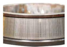
Fig. 37: Electric Corrosion
